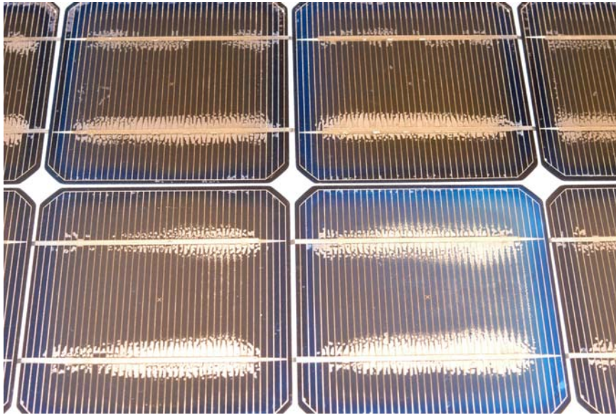
Bild 4-110: Detail der in Bild 4-109 gezeigten Delaminationen an einem Modul Arco Solar M55.
